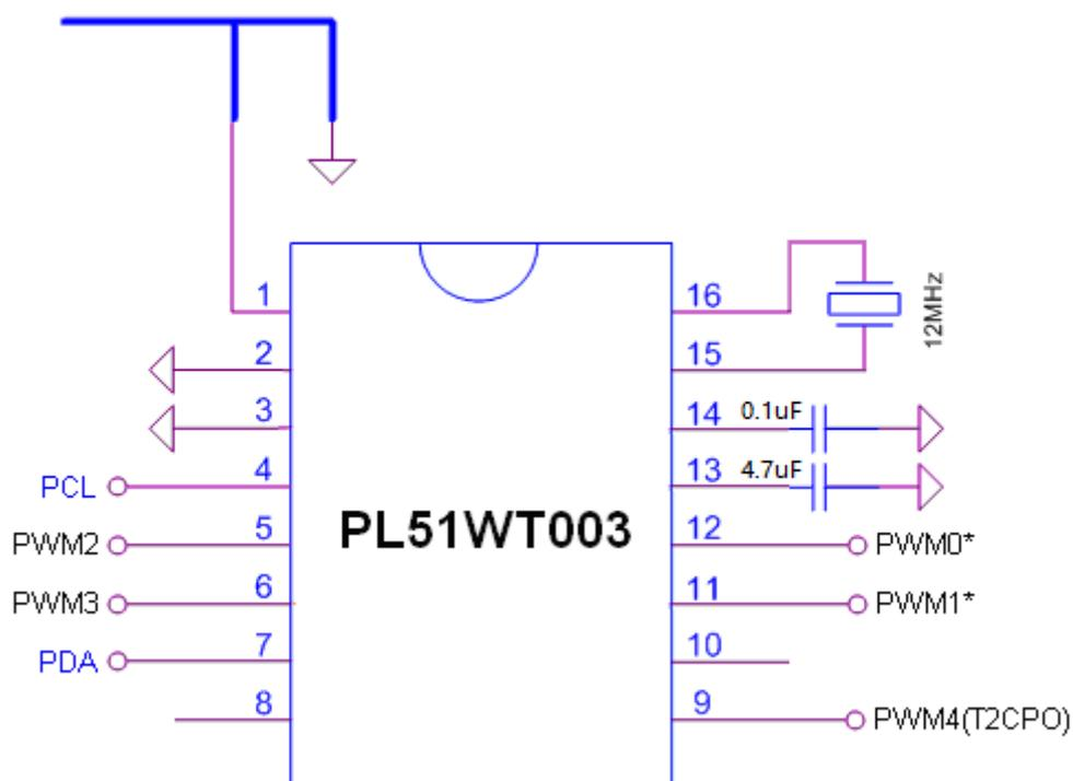
注：SOP16 的 PWM 为 4(12 位)+1(8 位)；使用 TSSOP20/SSOP24 时支持的 PWM 为 6(12 位)+1(8 位)，可以实现如“RGB+冷暖双色+分层灯”等更好的功能与效果。
